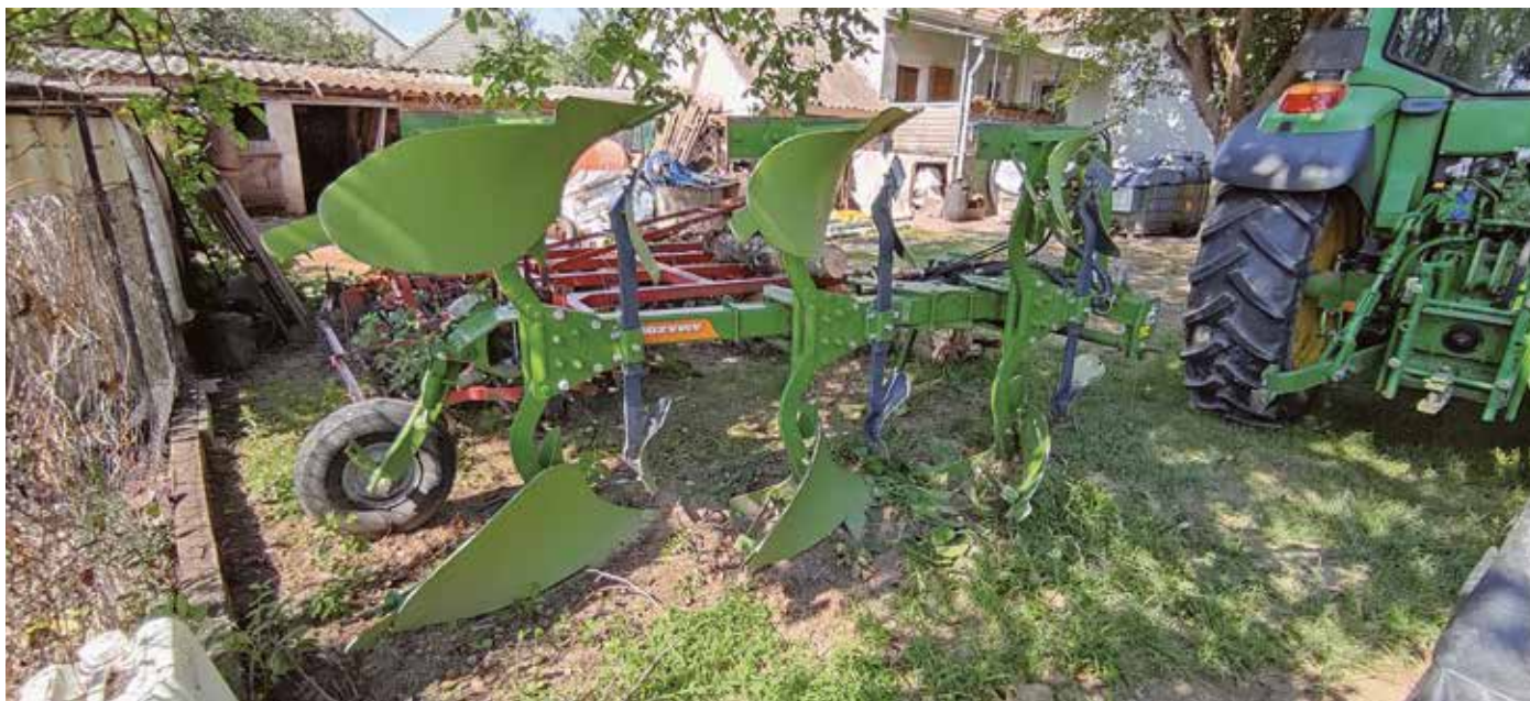
A pályázati forrásból beszerzett új eke váltva forgató és változtatható fogás szélességű is
